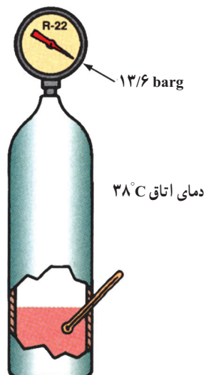
شکل ۲-۱۵- در دمای 38^{\circ}\text{C} فشار نسبی 13/6 \text{ barg} است.
